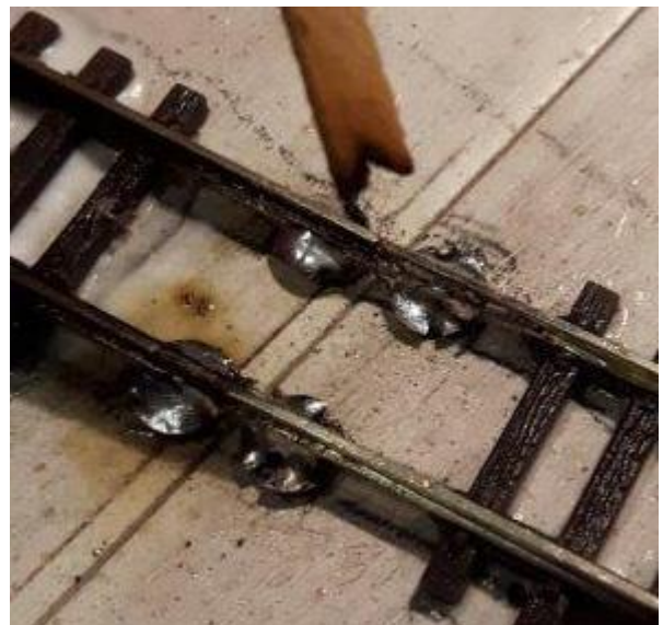
Het houten stokje houdt de rails op zijn plek.
