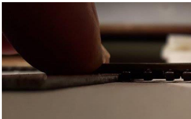
De printplaat is iets hoger dan de bielzen.
