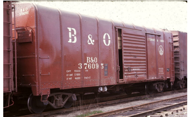
De wagontop wordt gekenmerkt door de ronde opbouw die bestaat uit tegen elkaar aan geschoven stalen bogen. Deze foto is uit 1973.
