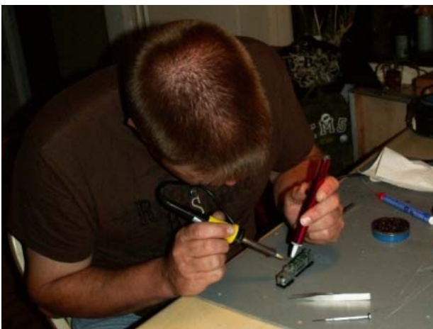
Rob soldeert de draden van het ledje aan een decoder vast.
