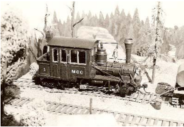
Forney, door de auteur gebouwd op het onderstel van een oud Rivarossi 0-4-0T locje. De schaal is On30. De kap is geheel scratchbuilt. De loc was een Cab-forward. De Rivarossi-motor is vervangen door een Mashima-motor en de flenzen zijn afgedraaid op RP 25 profiel.
